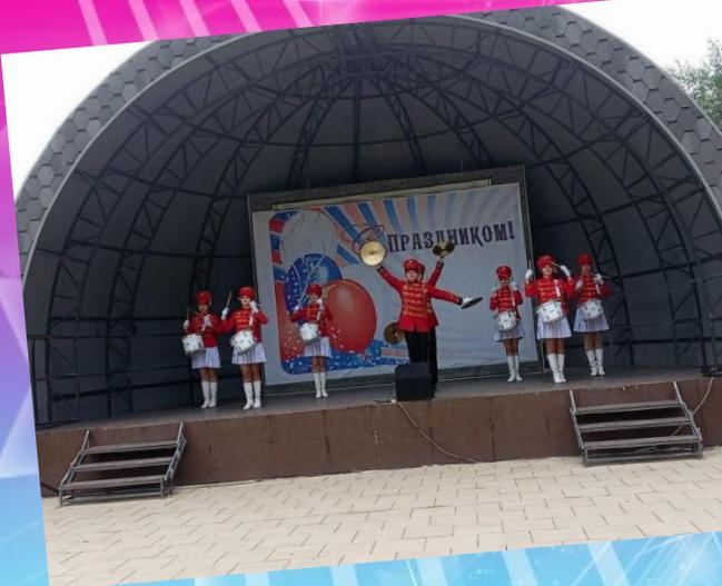
Проектом предлагается обустроить сценический стационарный комплекс состоящий из стального подиума высотой 1 метр на винтовых опорах с покрытием из влагостойкой ламинированной противоскользящей фанеры, с тремя лестницами в комплекте (две фронтальные, одна задняя) и павильона - арочная конструкция из стальных ферм, покрытая мягкой черепицей.
